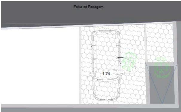
Este lugar abrange uma área de intervenção aproximada de 23.22m<sup>2</sup>. Efetuamos demolição do pavimento intrínseco ao estacionamento, para construção da rampa que vence a diferença de cota do respetivo estacionamento com o passeio, bem como pavimentação da área afeta.
